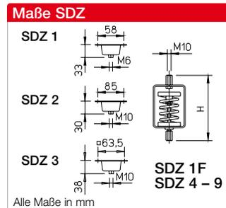
**Schwingungsdämpfer für Druckbelastung**
